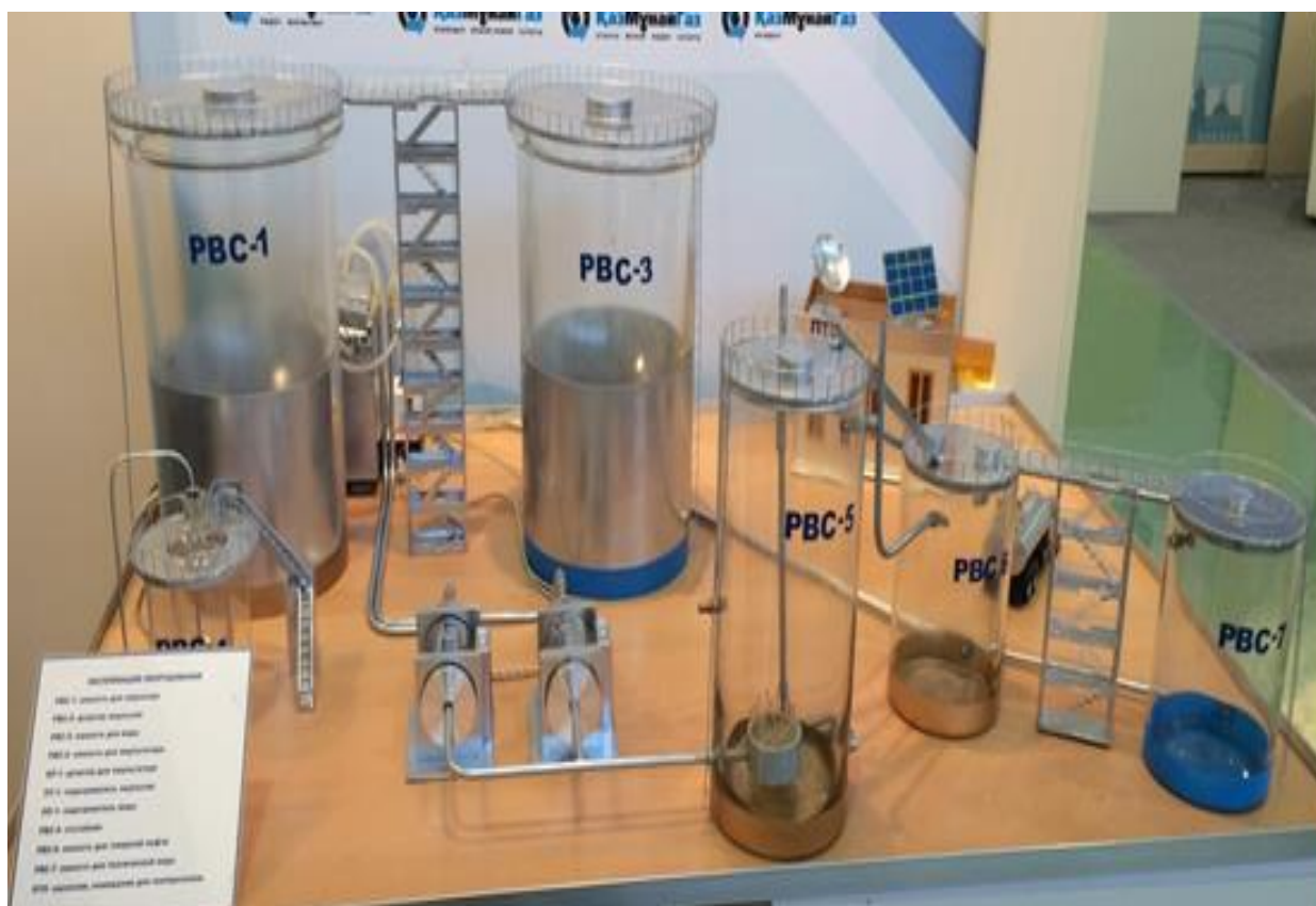
Рисунок 19 - Учебно-демонстрационный макет технологической схемы подготовки нефти (пример компоновки при внедрении деэмульгатора КНТУ-14), лист 1
