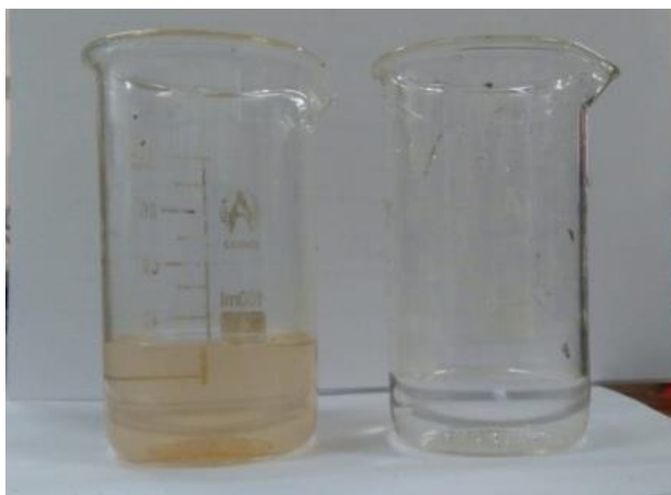
Рисунок 16- Пластовая вода месторождения Каражанбас проба 3/9 до и после обработки реагентом Al: сплав Вуда (90:10)
